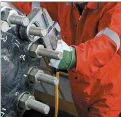
◀ La mayoría de las llaves de torque hidráulicas pueden accionarse mediante la bomba para llaves de torque Enerpac de la serie ZA4.
