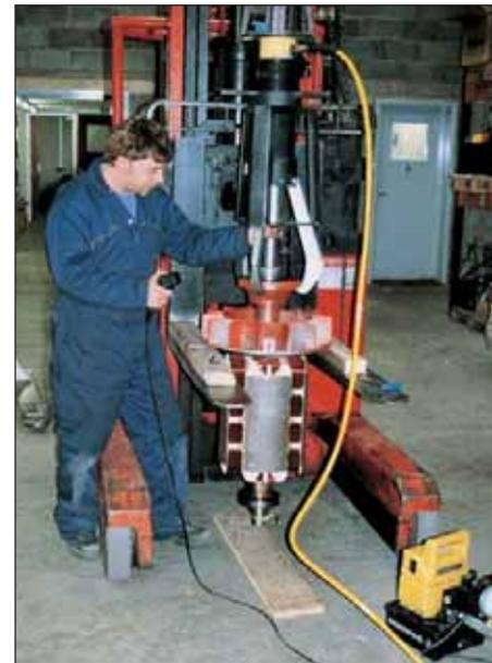
▲ Se utiliza un Extractor Hidráulico EPHR-116 para trasladar un motor eléctrico. El extractor se posiciona utilizando una placa de elevación.
