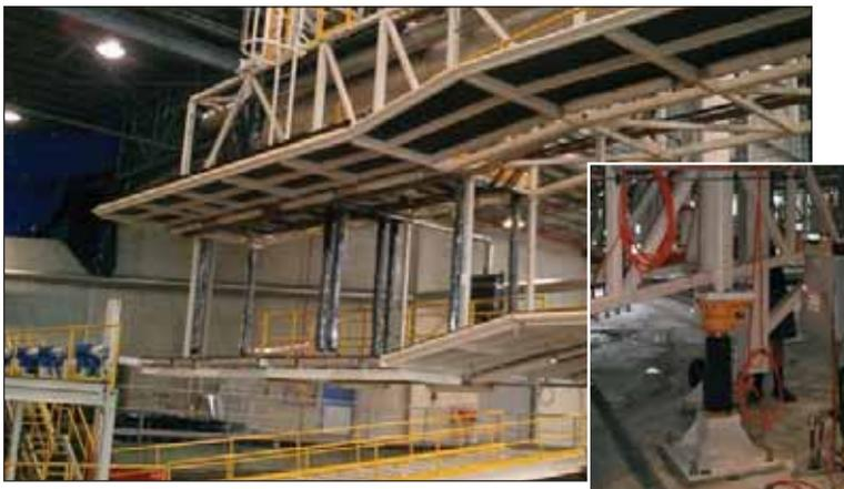
◀ Los actuadores Uni-Lift® fueron la opción ideal para posicionar y ajustar el complejo andamio para mantenimiento de aeronaves. La precisión del movimiento y la flexibilidad permitieron ejecutar el trabajo de forma eficiente y segura.
