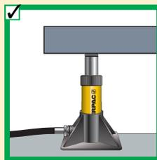
◀ Asegúrese de que haya un soporte firme para toda la superficie de la base del cilindro. Para lograr una mayor estabilidad, utilice el acoplamiento de la base del cilindro.
