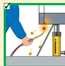
◀ Mantenga los equipos hidráulicos alejados del fuego o de temperaturas superiores a los 150 °F (65 °C).
