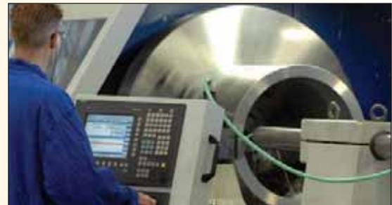
Enerpac utiliza las tecnologías más modernas de maquinado CNC y fabrica todos los cilindros hidráulicos grandes y especiales en sus instalaciones. Podemos maquinar diámetros de hasta 50 pulgadas con longitudes de hasta 240 pulgadas.
