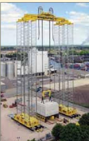
La torre automontable (ESET) Enerpac es un sistema de elevación de torre automontable que le permite construir una grúa pórtico sin estructuras de soporte desde el nivel del terreno. La torre automontable puede suministrarse en diversas capacidades y alturas y construirse con componentes modulares estándar, permitiendo una solución flexible a futuras demandas del proyecto.
