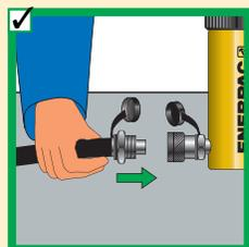
◀ Limpie ambas piezas de acople antes de realizar las conexiones. Utilice tapas guardapolvos cuando las piezas de acople no estén conectadas.
