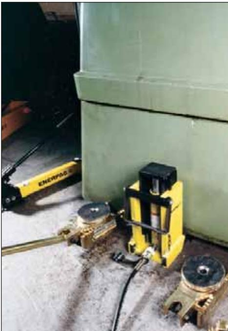
▼ Los patines de carga se pueden encargar por separado o como parte de un conjunto combinado.
