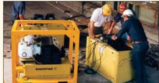
Enerpac diseña, ensambla y prueba en sus instalaciones unidades de potencia hidráulica pequeñas y grandes. Las unidades de potencia van desde 1/4 hasta 320 hp y se prueban con el sistema con el que están destinadas a funcionar.
