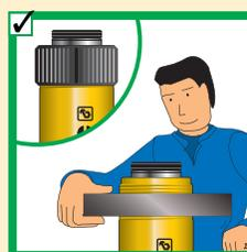
◀ Proteja siempre las roscas del cilindro que se utilizan con los acoplamientos.
