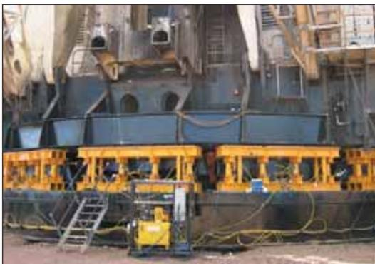
◀ Para evitar contrapresión y para aumentar la velocidad de retracción de cilindro, al utilizar mangueras largas, la mejor opción es la gama de mangueras HC-7300 de Enerpac con diámetro interno aumentado.
