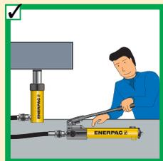
◀ No utilice extensiones para la palanca. Si se usan correctamente las bombas manuales peran con facilidad.
