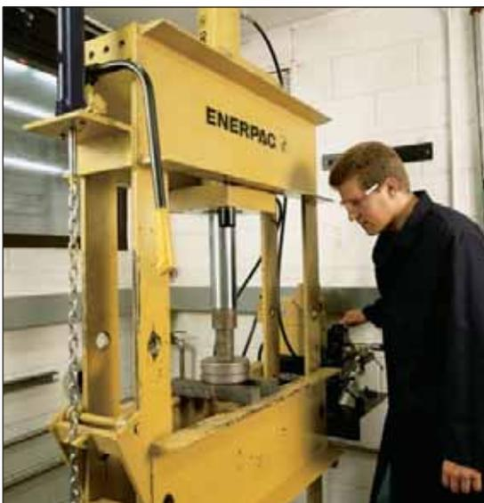
◀ La prensa Enerpac con bastidor en H facilita la remoción del eje de este montaje.
