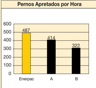
*Pruebas de laboratorio internas en un procedimiento de apriete estándar de la brida de una tubería con 14 pernos de 1 1/2".*
