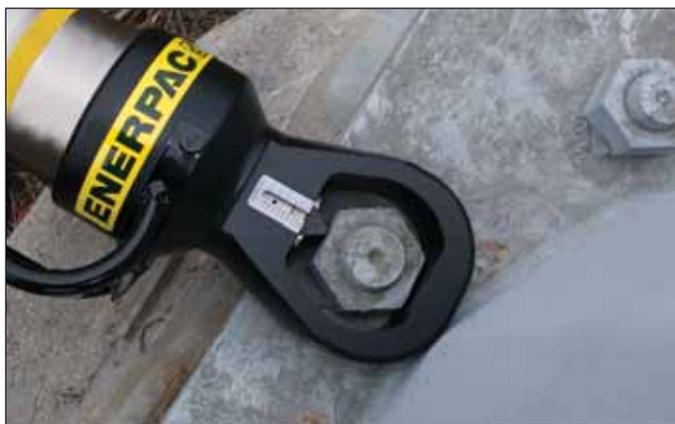
◀ Las tuercas muy corroídas y gastadas pueden cortarse y retirarse rápidamente utilizando un cortador de tuercas de la Serie NS.
