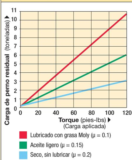
Ejemplo de cómo un lubricante puede reducir el efecto de fricción y convertir más torque a precarga de perno.
