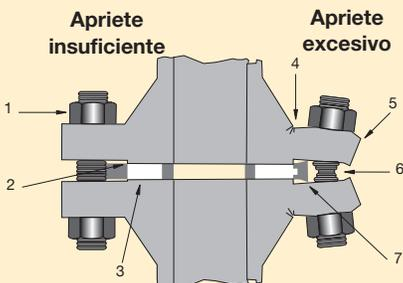
1. El perno se afloja debido a cargas de vibración cíclicas.
