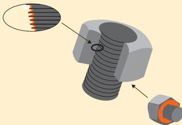
Los puntos de fricción siempre deben lubricarse al usar el método de apriete con torque.
