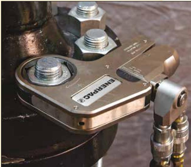
**◀ La llave dinamométrica estrecha W4000X en una brida de tubo ANSI**
