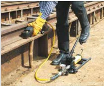
◀ Quitar fácilmente las tuercas oxidadas durante la construcción de esta vía férrea, es sólo una de las muchos ejemplos de aplicación del cortatuercas de Enerpac.
