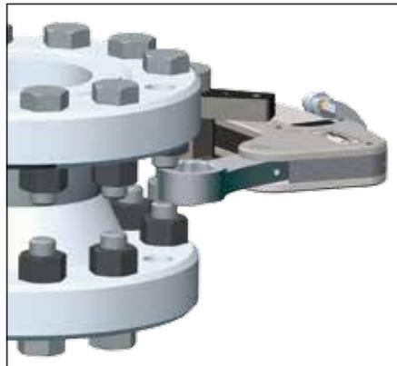
▼ La llave WCR debe reposicionarse tras cada ciclo de apriete, operando la bomba en la dirección de retracción. La herramienta no contiene un retorno por muelle.
