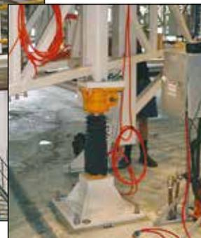
◀ Los actuadores Uni-Lift® fueron la elección ideal para posicionar y ajustar un complejo andamiaje para el mantenimiento de aviones. La precisión de movimiento y la flexibilidad fueron una gran ventaja para llevar a cabo el trabajo de forma eficiente y segura.
