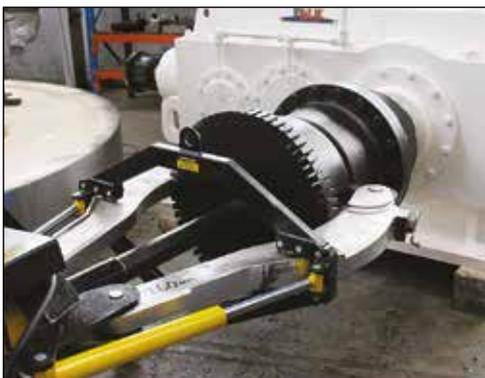
◀ Con el extractor hidráulico EPH-1002E se extrae rápida y sencillamente este acoplamiento de transmisión de su eje.
