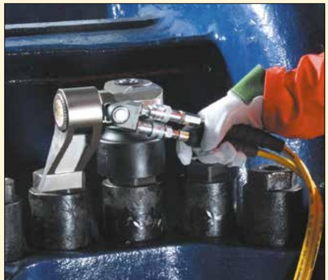
▼ En la foto: Unidad de accionamiento con cabezales intercambiables
