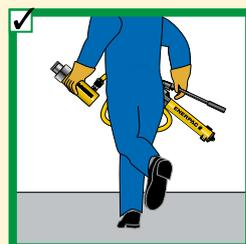
No levante el equipo hidráulico por las mangueras.
