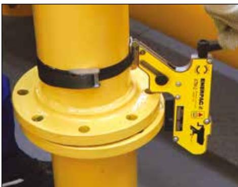
▼ Aquí se muestra la ATM-9 con el manómetro y adaptador opcionales.
