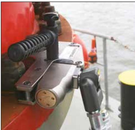
◀ Las llaves de acero de Enerpac accionadas por bombas neumáticas aseguran que la revisión y el mantenimiento sean fáciles y seguros en el taller.
