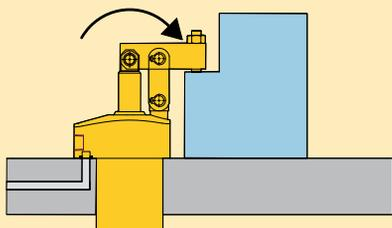
La posición del brazo se cambia fácilmente sin el uso de herramientas.
