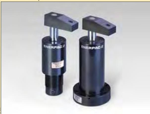
▶ Los cilindros Collet-Lok® de Enerpac están diseñados para sostener la pieza de trabajo de manera mecánica, después de eliminar la presión hidráulica. Las capacidades de sujeción varían entre 1000 libras y 8500 lb
