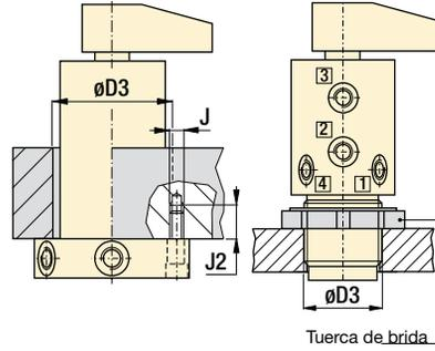
**Funciones del orificio de conexión hidráulica**
