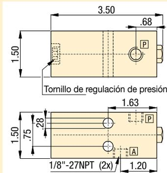
**Válvula manual de cierre de seguridad V-12**
