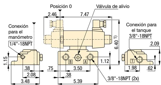
**Válvula modular de montaje remoto**
