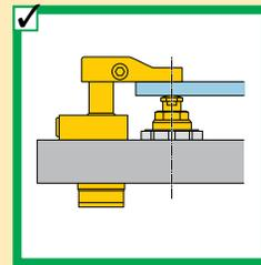
No aplique cargas descentradas. La fuerza de sujeción debe ejercerse directamente sobre el punto de apoyo.
