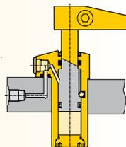
■ Sujeción giratorios usados conjuntamente con soportes para piezas y otros componentes Enerpac a fin de sujetar firmemente piezas de trabajo durante operaciones de maquinado.
