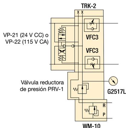
■ PRV-1 conectada con manifold remoto WM-10.
