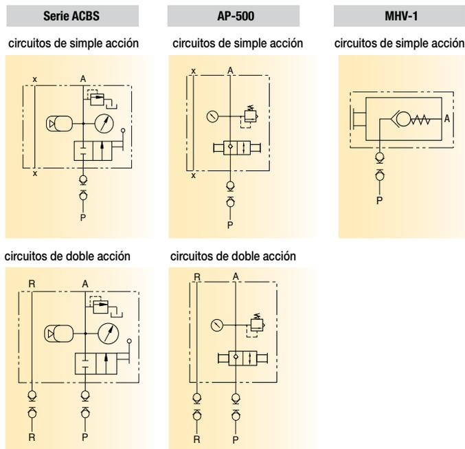
Paquete de acumulador ACBS-202 utilizado para mantener la presión en un dispositivo de máquina herramienta.
