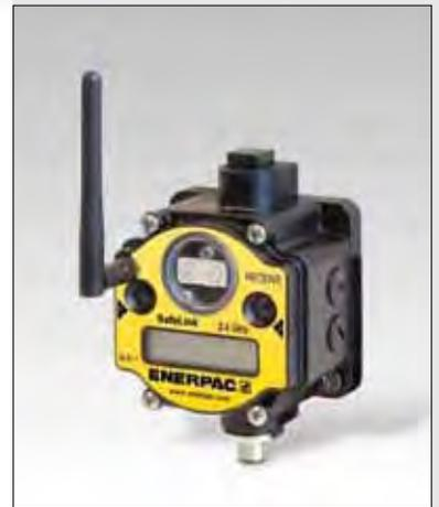
Las unidades RECIBIR SafeLink pueden suministrar a las salidas mediante el uso del protocolo Modbus RTU RS-485 estándar. Esta salida usa el conector de 5 contactos en la unidad RECIBIR. En caso que se prefiera protocolo Ethernet, está disponible un PUENTE ETHERNET para convertir el Modbus RTU R-485 a ETHERNET IP o Modbus TCP/IP.
