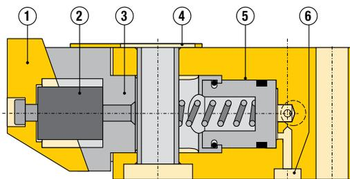
La mordaza móvil ① y el diseño flexible de conexiones ② permiten el movimiento lateral y eliminan cualquier momento flector. El diámetro interno del cilindro acabado por rodillo ③ prolonga la vida útil de la junta. El protector desmontable ④ evita el ingreso de virutas y permite una fácil limpieza.
