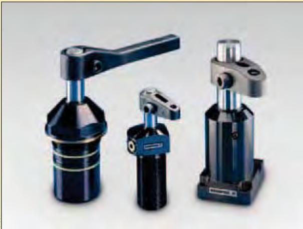
Los sujeción giratorios Enerpac permiten la sujeción y colocación de piezas sin obstrucciones. El vástago del émbolo y el brazo de sujeción giran 90 grados tanto hacia la izquierda como hacia la derecha y luego recorren una distancia adicional hasta sujetar la pieza. Cuando se libera la presión de sujeción, el brazo de sujeción gira 90 grados en la dirección opuesta para permitir el desmontaje de la pieza y la colocación de la pieza nueva.
