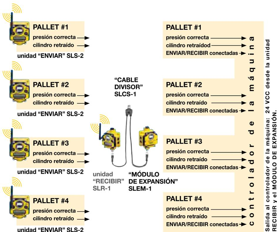
Sistema más grande con interfaz de máquina Modbus RTU
