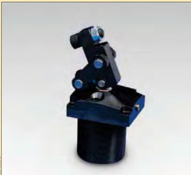
▶ El amarre de enlace permite la carga de partes sin obstrucciones y grandes fuerzas de amarre. Los cilindros hidráulicos se extienden para proporcionar fuerza de amarre y se retraen para permitir la extracción parcial.
