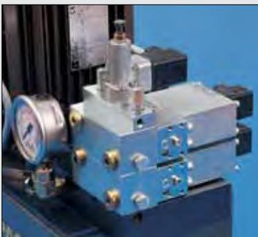
ZW5VPSEE100 con colector múltiple para válvulas serie VP o CETOP 03, sin controles eléctricos ni manómetro
