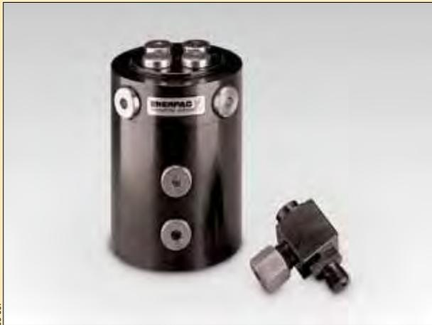
Los acopladores giratorios son unas conexiones diseñadas especialmente para transferir el líquido presurizado desde la línea fija de suministro a un dispositivo giratorio. Se usan en dispositivos de sujeción de piezas o de fijación tales como dispositivos instalados en líneas de trabajo rotativas.
