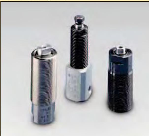
▶ Los cilindros roscados están diseñados para tareas de posicionamiento, sujeción y eyección de la pieza de trabajo cuando existen restricciones de espacio. El modo de avance y retracción de los modelos de doble acción permite la instalación de accesorios de sujeción en el émbolo para acciones de tracción y empuje. Los cilindros se pueden montar con soporte horizontal para posicionar la pieza de trabajo contra los topes. Ideal para sostener o posicionar una pieza.
