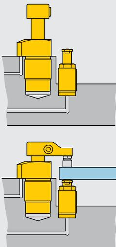
Soportes para piezas de avance por resorte con émbolos extendidos, esperando la próxima pieza de trabajo.
