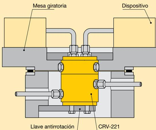
En esta aplicación se instalan 8 acopladores giratorios CRV-221 para accionar las prensas individuales de una mesa de prensa giratoria de ocho estaciones.
