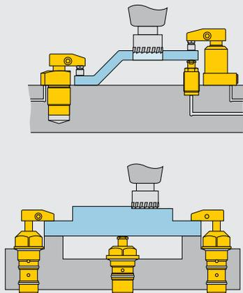
Para poder cargar las piezas lateralmente sobre los soportes correspondientes, se utilizan modelos de avance hidráulico.
