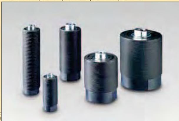
▶ Los cilindros roscados están diseñados para tareas de posicionamiento, sujeción y eyección de la pieza de trabajo cuando existen restricciones de espacio. Los modelos de doble acción también son aptos para aplicaciones de fabricación, tales como la perforación industrial.
