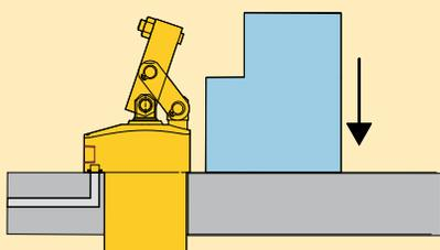
A medida que el cilindro se extiende, el brazo gira para sujetar una pieza en su lugar.
