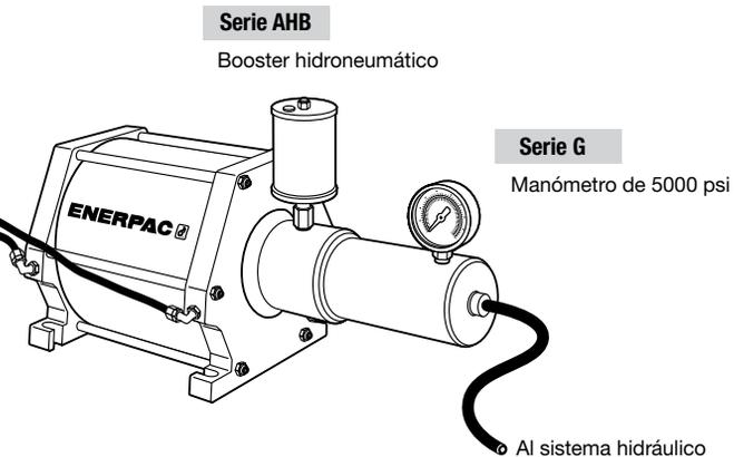
■ En configuraciones automatizadas de sujeción con componentes hidráulicos y neumáticos, los Boosters serie AHB se utilizan como fuente de alimentación para el sistema hidráulico.
