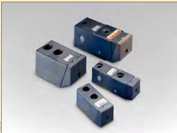
Las abrazaderas de tiro descendente Enerpac están diseñadas para permitir el maquinado de la cara superior sin obstrucciones. El movimiento vertical y horizontal independiente logra grandes fuerzas laterales y de tiro descendente para sujetar la pieza de trabajo firmemente contra la mesa de maquinado o el dispositivo. Las fuerzas de tiro descendente equivalen aproximadamente al 33% de la fuerza de sujeción.
