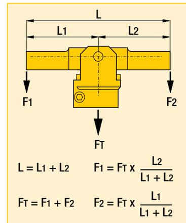
Dos piezas de trabajo sujetadas simultáneamente con un cilindro giratorio de doble acción mediante el brazo en "T" pivotante de Enerpac.
