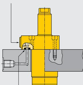
Orificio integrado con O'rings
