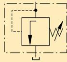
El tipo más común de válvula de control de presión es la válvula de alivio de presión.
