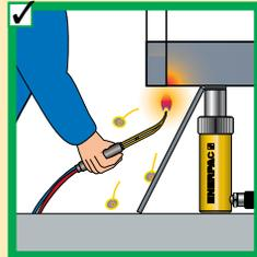
Mantenga los equipos hidráulicos alejados del fuego y de temperaturas superiores a los 150 °F / 65 °C.
