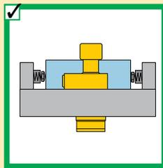
Para sostener las piezas hasta que los sistemas hidráulicos se activen, utilice dispositivos mecánicos y no los dedos.
