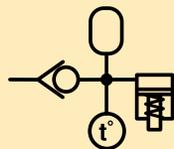
■ Paquete de acumulador ACBS-202 utilizado para mantener la presión en un dispositivo de máquina herramienta.
