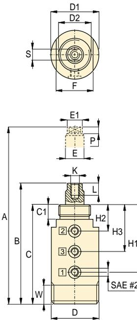
**Funciones del orificio de conexión hidráulica**
