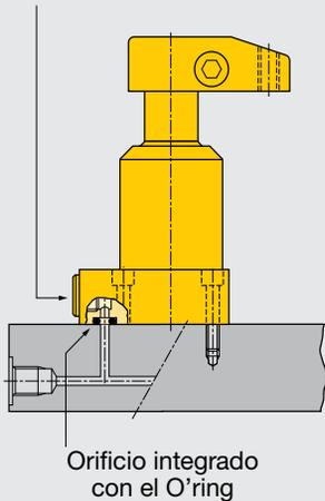
■ Sujeción giratorios de brida inferior montados en la cara del portapiezas.
