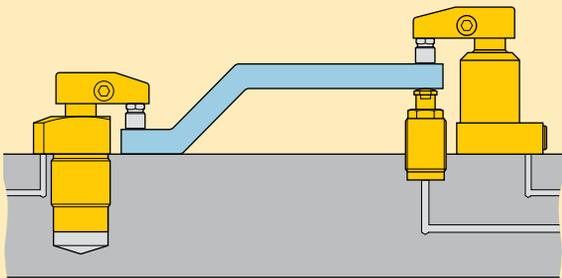
■ Soportes para piezas de brida inferior colocados cerca del área de maquinado para minimizar la deflexión de la pieza.
