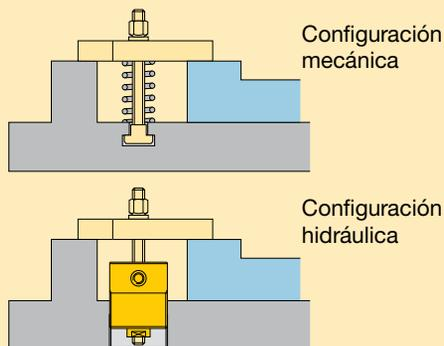
Los elementos mecánicos tradicionales de un plato de fijación son remplazados por un cilindro hidráulico de émbolo hueco.
