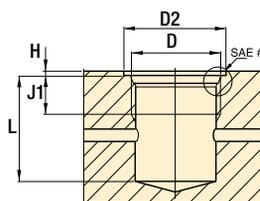
**Nota:** - incluye O-rings. Para obtener información adicional acerca del maquinado de la cavidad consulte las normas SAE para rosca interna lineal, saliente de O-rings o comuníquese con el Departamento de Asistencia Técnica de Enerpac.
