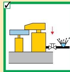
Utilice válvulas de retención para conservar la presión hidráulica de los dispositivos de sujeción en caso de fallas en la línea hidráulica.
