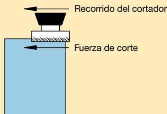
$$\text{Fuerza de corte} = \frac{\text{Hp del Husillo} \times 26406}{\text{Velocidad de corte}}$$
