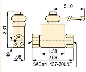
**Válvula de amortiguación automática V-10**
