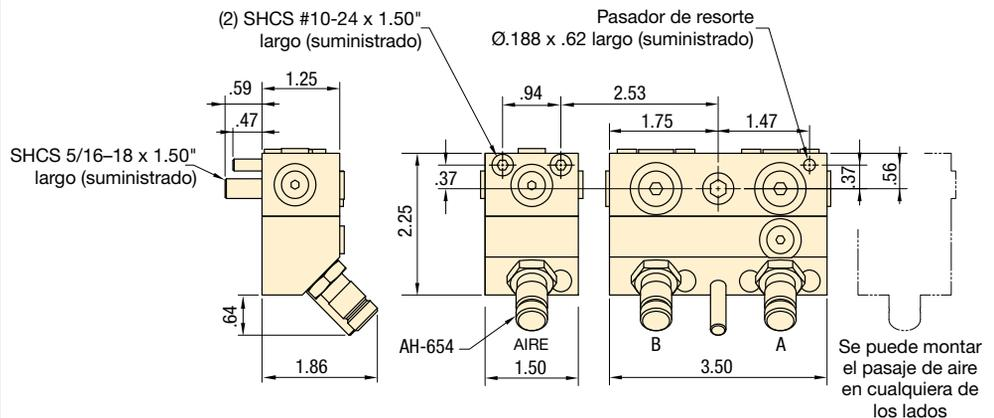
**MCRC-21 con MCRA-11** Receptor con pasaje de aire y válvula de retención P.O.
